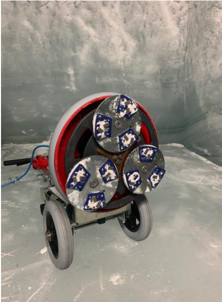
Die Diamant-Segmente DS-Rex gewähren eine glatte Oberfläche.
